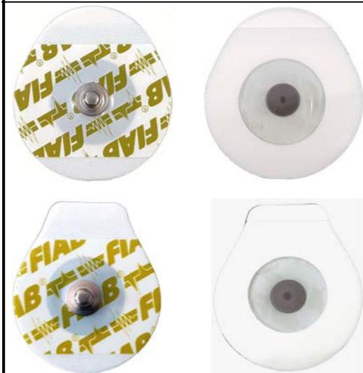
Elettrodi monouso per ECG in GEL solido con sensore in Ag/AgCL (Argento/Argento Cloruro) e clip in acciaio.
