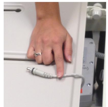
Figura 5 – Scollegamento del cavo della batteria dalla centralina di comando
